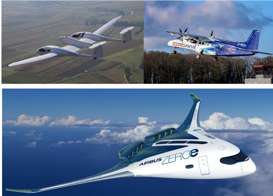
*Figura 8. Diferentes prototipos de aeronaves propulsados por hidrógeno. Arriba izquierda: modelo HY4; arriba derecha: modelo Dornier 228; abajo: uno de los tres prototipos presentados por Airbus Zeroe.*
