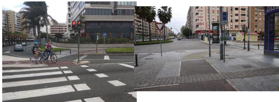
Dos ejemplos de vías ciclistas no directas, una debido a una curva demasiado cerrada y debido a una intersección demasiado sinuosa.
