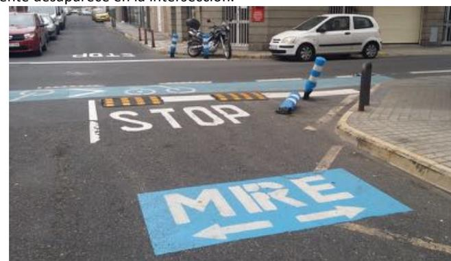
Elementos de señalización y balizamiento protegiendo una vía ciclista dispuesta en sentido contrario a la circulación motorizada.
